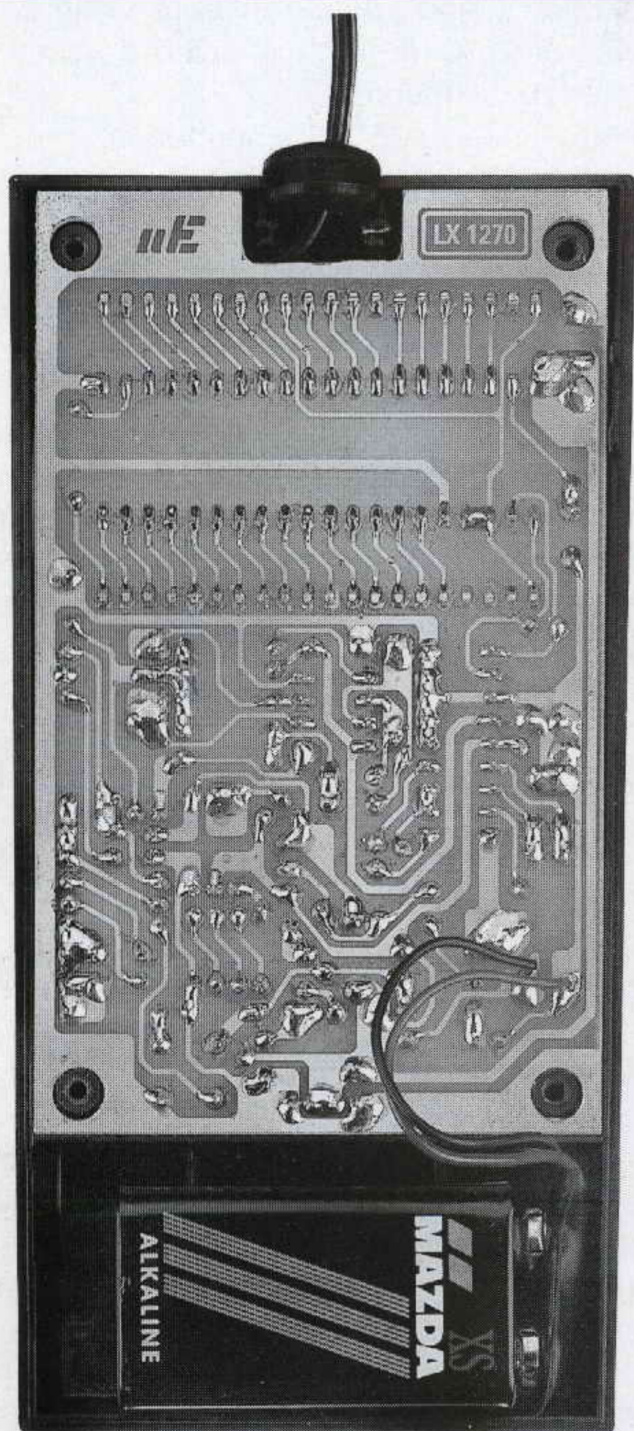
Fig.10 Foto del circuito stampato inserito all'interno del mobile. Quando stagnate i due fili del cordone d'uscita cercate di non cortocircuitare le due piste in rame.
