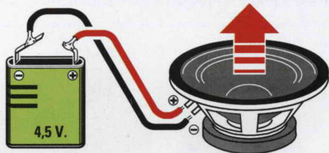
Fig.176 Se volete vedere come si muove la membrana di un altoparlante procuratevi una pila da 4,5 volt e collegatela ai suoi terminali. Se rispetterete la polarità, il cono si sposterà verso l'esterno.
